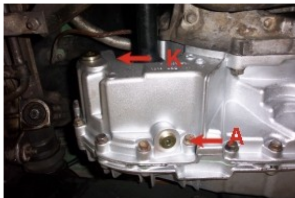
K = Kontrollschraube A = Ablassschraube
