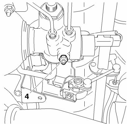
**Задняя подвеска**, отверните на один оборот винт сброса давления (4).
