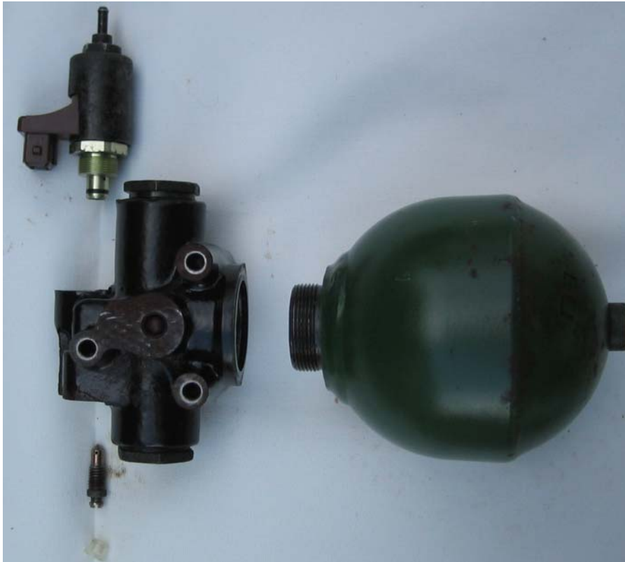
Vue de dessus. On retrouve l'électrovanne en haut, et la vis de purge démontée en bas. Ainsi que la sphère à droite.
