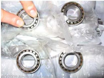
Новые подшипники необходимо проверить при покупке. Выложите их на прилавок, прокрутите с нажимом, выбирая зазор. Затем положите пальцы по диаметру, как на фото. Нажимая на внутреннюю обойму попробуйте наклонить её относительно наружной. Удалось. Отбраковывайте и требуйте следующий. **Люфта быть не должно.** Если запчасти в наличии и Вы готовы взяться за инструмент - просмотрите заводскую документацию по ремонту.
