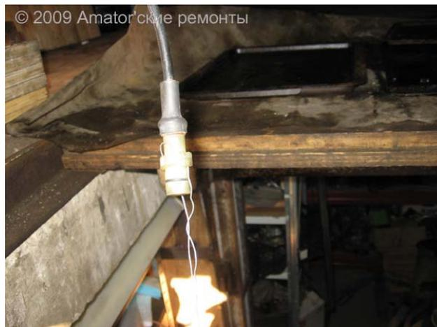
Выщелкните тормозную трубку из пластикового держателя на рычаге. Пробуйте открутить штуцер
