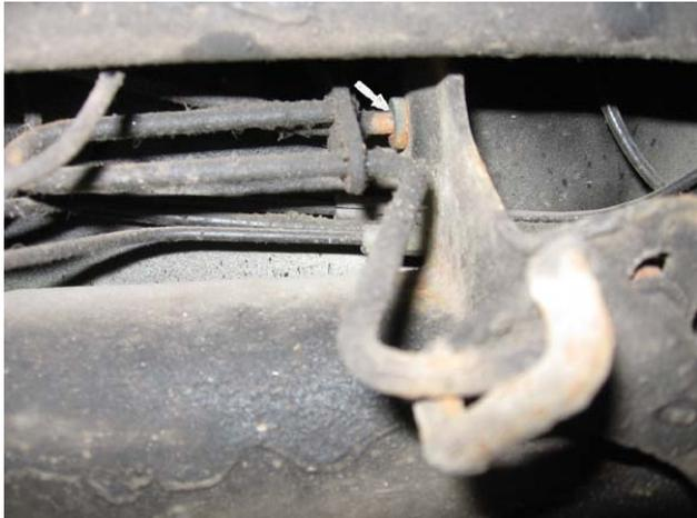
После этого обязательно проверьте как ходят рычаги. Подвигайте их вверх вниз. Если дистанционная шайба толще, чем нужно, рычаги будут двигаться плохо. Закрутите болт сброса давления. Заведите машину, если отсоединялись суппорты - необходимо прокачать задние тормоза.
