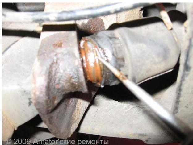
Снимите оба грязезащитных щитка задних колёс. На ВХ с АБС для снятия щитка надо отстегнуть защёлку проводки к датчику.
